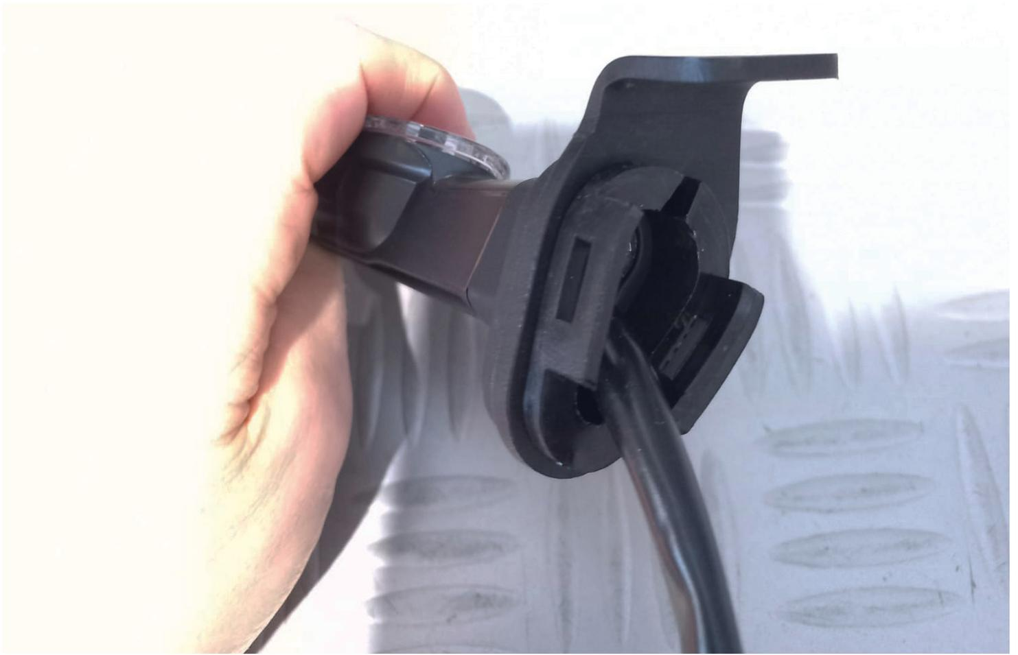
**Inserire, forzando la gomma della freccia, il supporto fornito nel kit**
